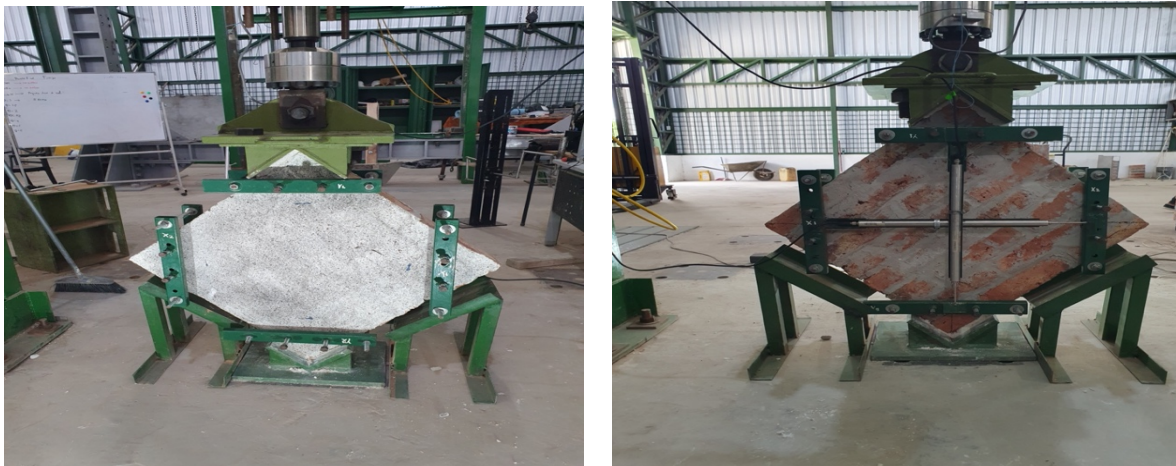
Figura 9: Ensayo de muretes sin reforzamiento
