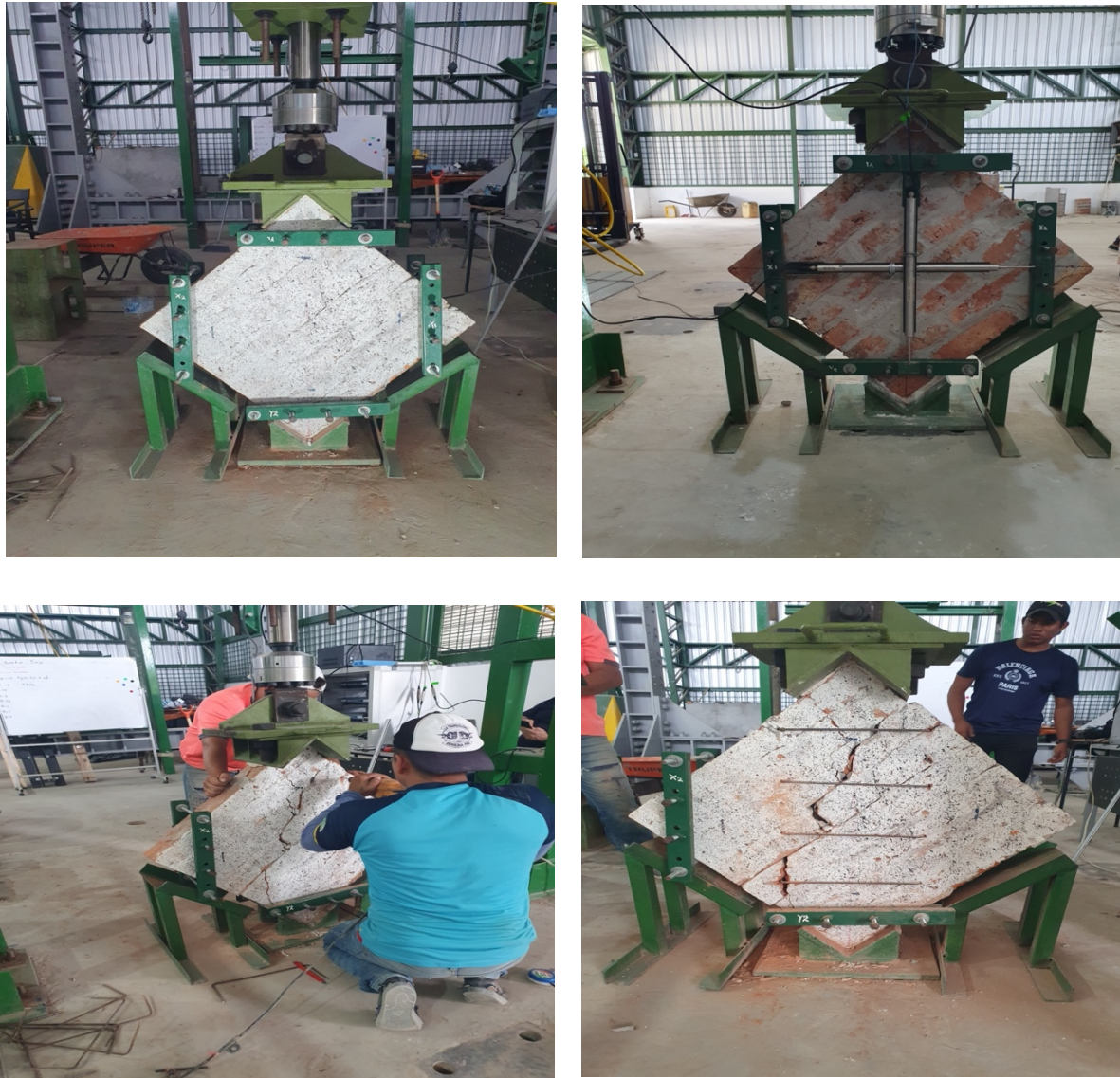
Figura 17: Ensayo de muretes rotos en sitio y reparados con grapas
