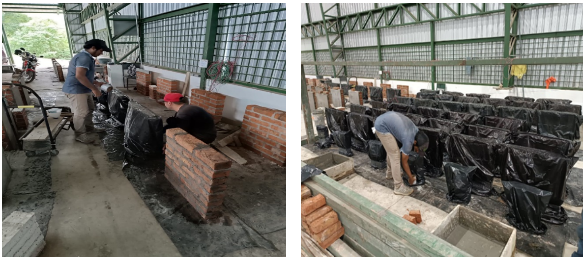
Figura 6. Almacenaje de los muretes y prismas.
