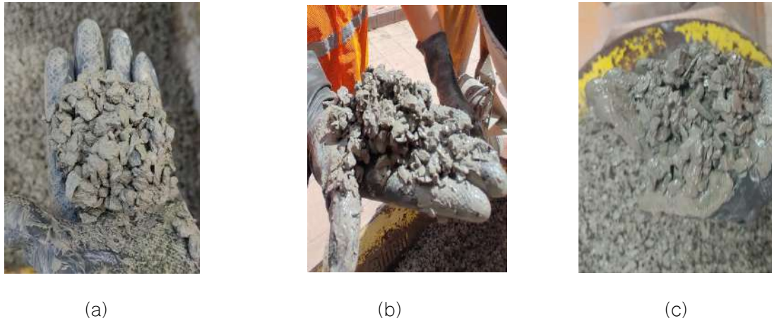
Figura 6 Creación de la esfera de hormigón en estado fresco: (a) relación a/c=0.26 , (b) relación a/c=0.34 , (c) relación a/c=0.42 .
