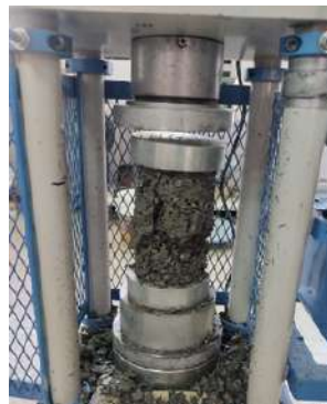
Figura 2 Ensayo a compresión
