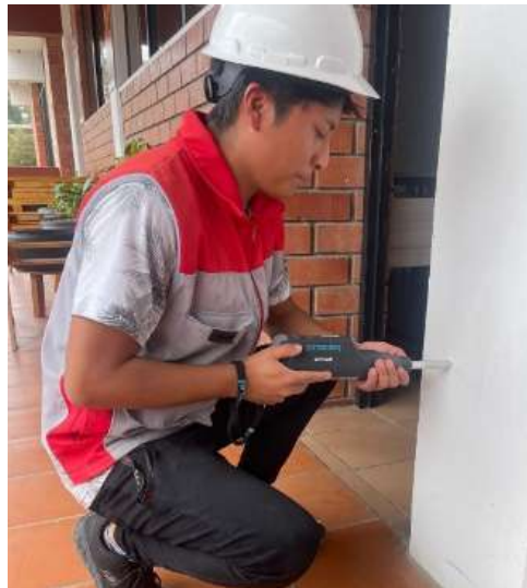
Figura 7: Recogida de datos con esclerómetro.
