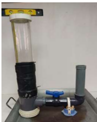
Figura 4 Ensayo de permeabilidad
