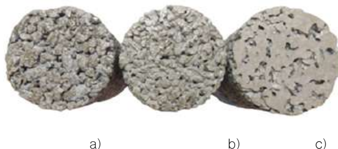
Figura 5 Comportamiento de la pasta de cemento: a) a/c 0.26. b) a/c 0.34. c) a/c 0.42
