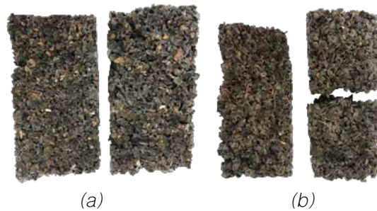
Figura 13 Falla a tracción indirecta: (a) 2 porciones longitudinales, (b) 3 porciones
