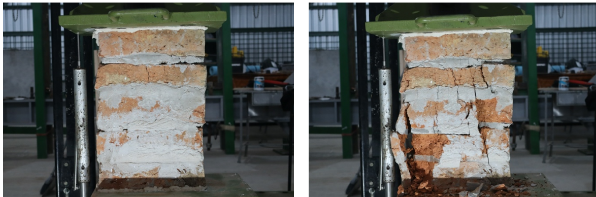
Figura 19: Ensayo de prismas
