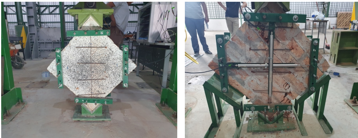
Figura 13: Ensayo de muretes con grapas sin anclaje sin resina
