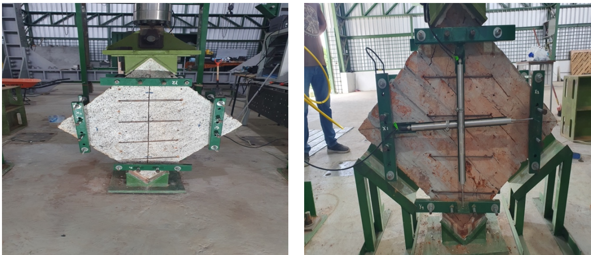
Figura 15: Ensayo de muretes con grapas sin anclaje con resina
