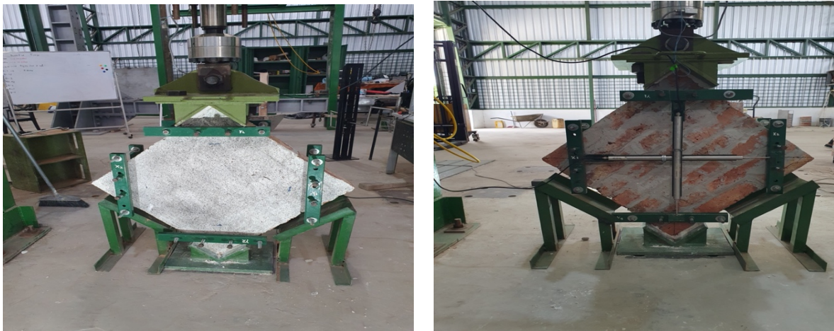
Figura 9: Ensayo de muretes sin reforzamiento
