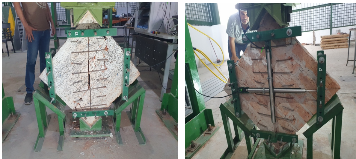
Figura 11: Ensayo de muretes con grapas con anclaje de reforzamiento
