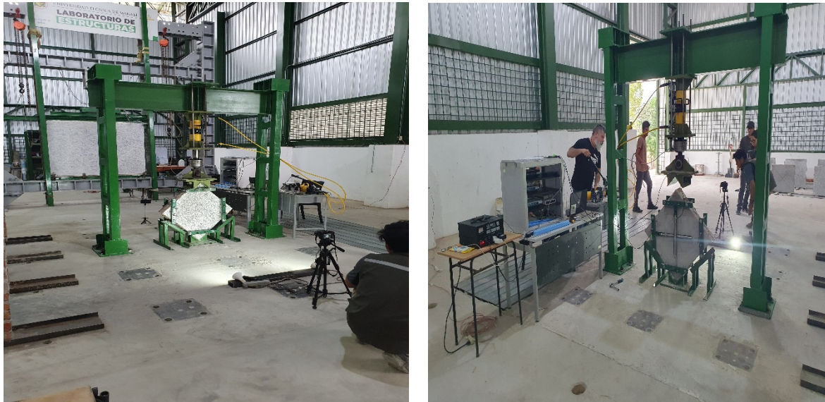
Figura 7. Marco de reacciones del Laboratorio de Estructura de la Universidad Técnica de Manabí.
